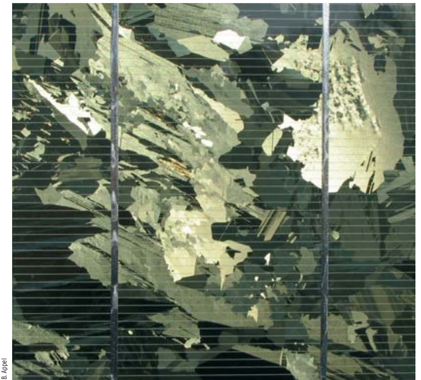
UNE CELLULE PHOTOVOLTAÏQUE en silicium multicristallin.
